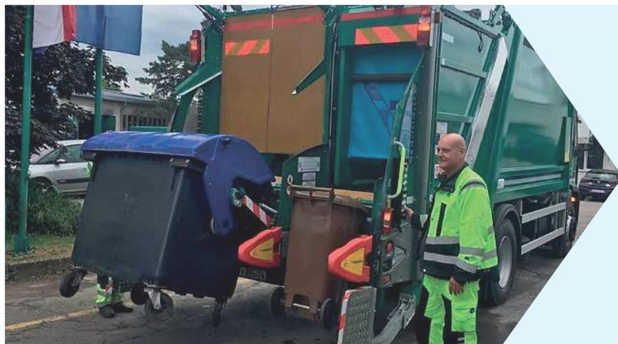
U 2019. nabavljeno je i vozilo za istovremeni odvoz dvije vrste otpada. Riječ je o posebnom vozilu za sakupljanje i prešanje svih vrsta otpada (miješani komunalni otpad, papir, biootpad, plastika), s dvije neovisne (odvojene) komore za prešanje, koje omogućuju istodobno praznjenje do 3 spremnika. Ovo je prvo takvo vozilo u voznom parku podružnice Čistoća.
